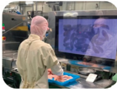
X線検査装置による鶏肉 (主に骨片)のチェック
