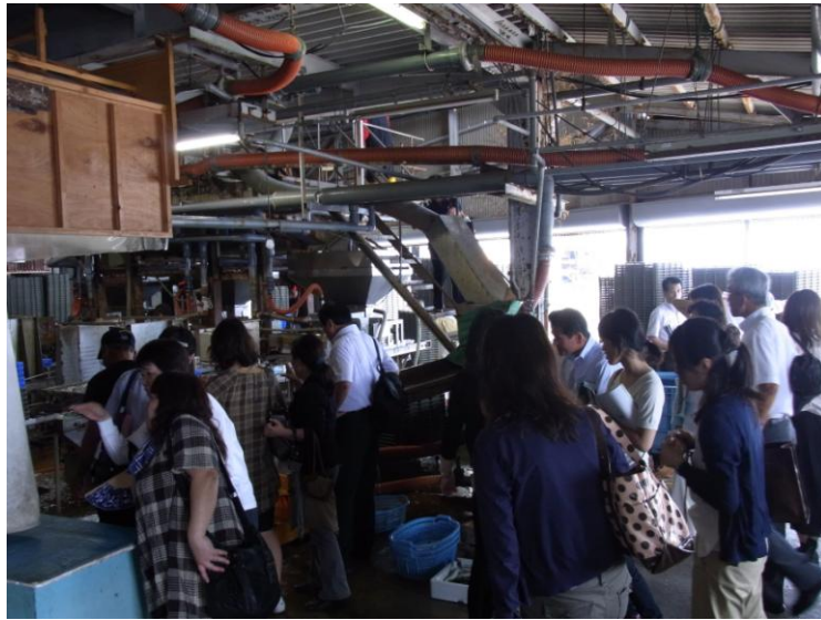
天井のパイプを通り片口いわしが工場内へ入ります。
